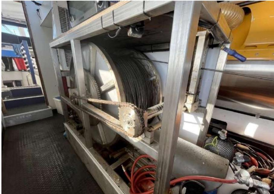
Figura 20. Guincho com cabo de aço para o sonar.
