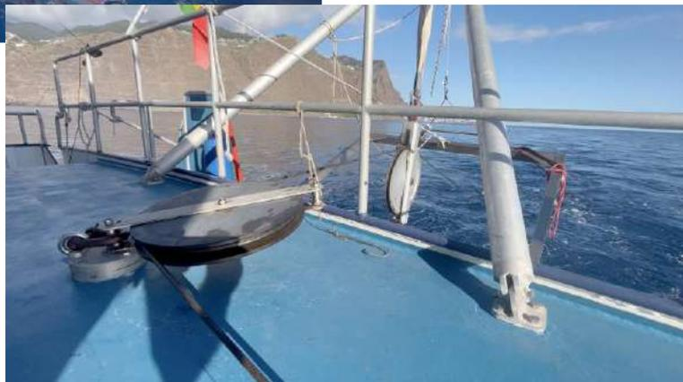
Figura 17. Rolos que guiam o cabo do sonar.
