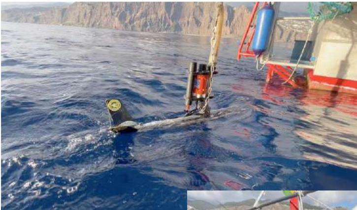
Figura 16. Sonar de varrimento lateral com recetor USBL montado.
