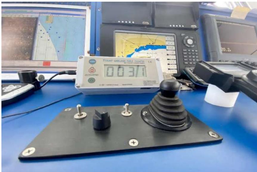
Figura 18. Controle do sistema de sonar com monitores, sonda e contador de cabo.
